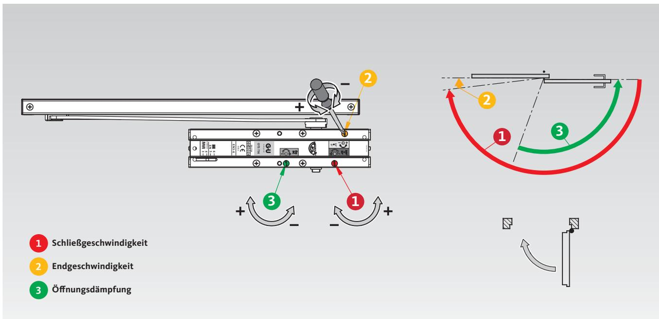
Türschließer von Gretsch-Unitas lassen sich durch die Einstellung verschiedener Parameter perfekt auf die individuellen Bedürfnisse und Gegebenheiten anpassen. Das betrifft insbesondere die Einstellung von Schließgeschwindigkeit, Endgeschwindigkeit und Öffnungsdämpfung über klar gekennzeichnete Ventile.
