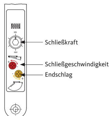
**Falztürschließer 20 – EN 1–2 (= Türflügelbreiten bis 900 mm)**
