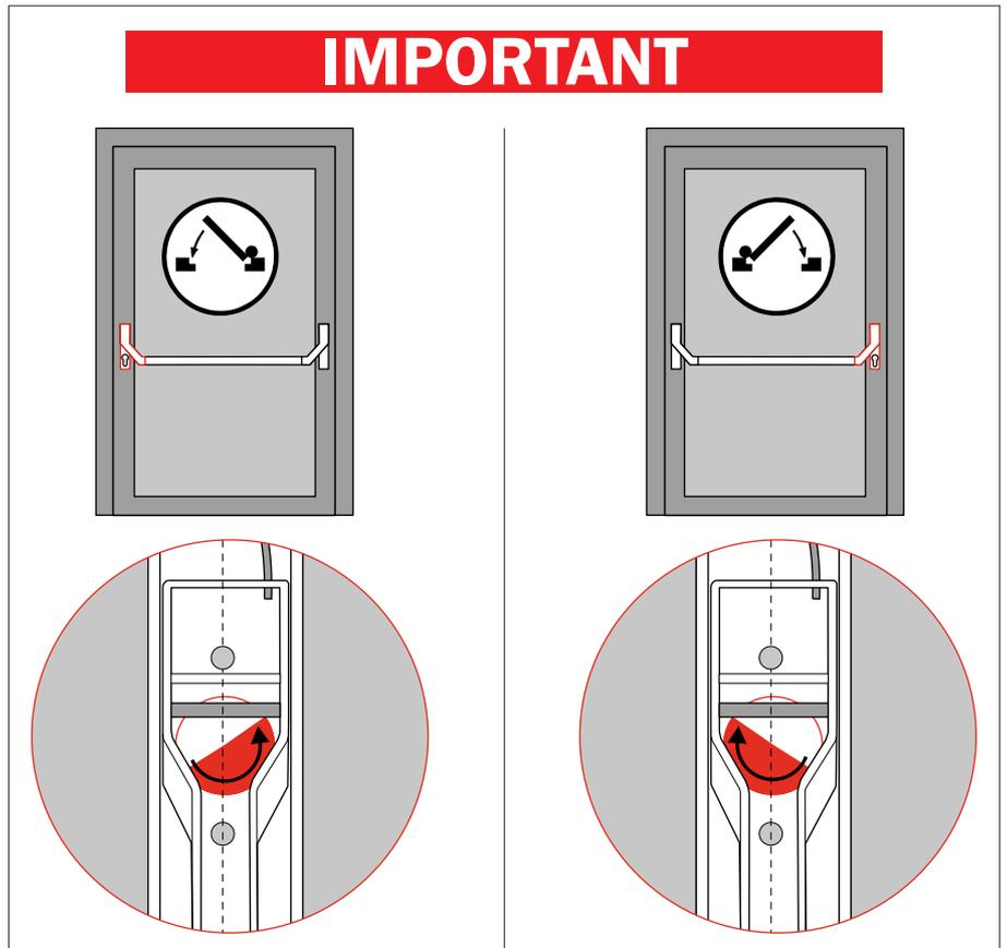
**9** Fissaggio lato cerniere - *Hinge side fixing*
