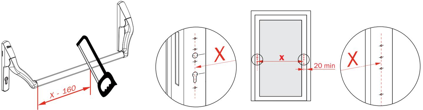
**8** Fissaggio lato serratura - *Lock side fixing*
