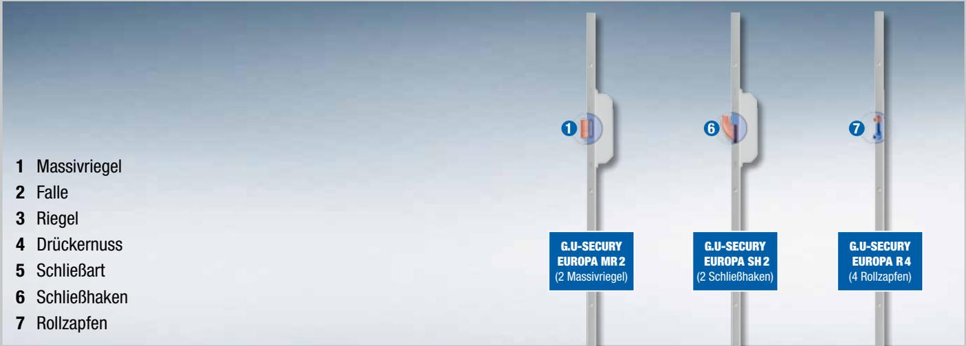
Die drückerbetätigte Schlosserie G.U-SECURITY EUROPA gibt es mit 2 oder 4 Zusatzverriegelungen. Die Tür wird damit, auf die gesamte Türhöhe bezogen, 3- bzw. 5-fach verriegelt. Der Massivriegel und Schließhaken haben es in sich: Eine gehärtete Stahleinlage macht ihn durchsägtresicher (nach SKG-NL).
